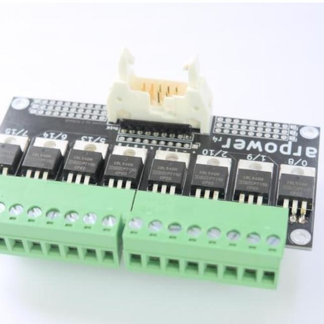
La partie enfichable en place, on termine la soudure par le connecteur 10 pins blanc. Attention au sens, l'encoche du bon côté.
